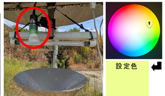
図2 補助LED設置状況と調色設定
