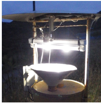
図1 主LED灯を設置した予察灯の点灯時の様子
