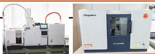
左：熱分解ガスクロマトグラフ質量分析計 令和7年度設置 右：X線CT装置 令和6年度設置
