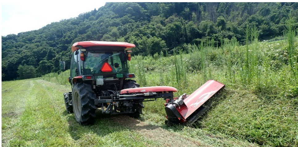
(写真) トラクタ牽引草刈機による水田斜面の草刈り作業
