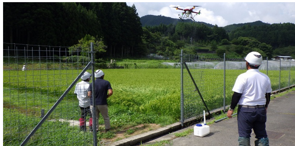
(写真) 農業用ドローンによる水稲防除作業
