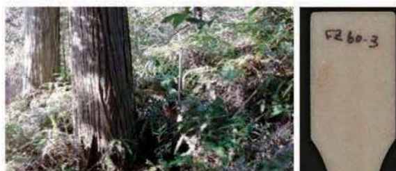
図1 山地埋設地と5か月後の試験片
