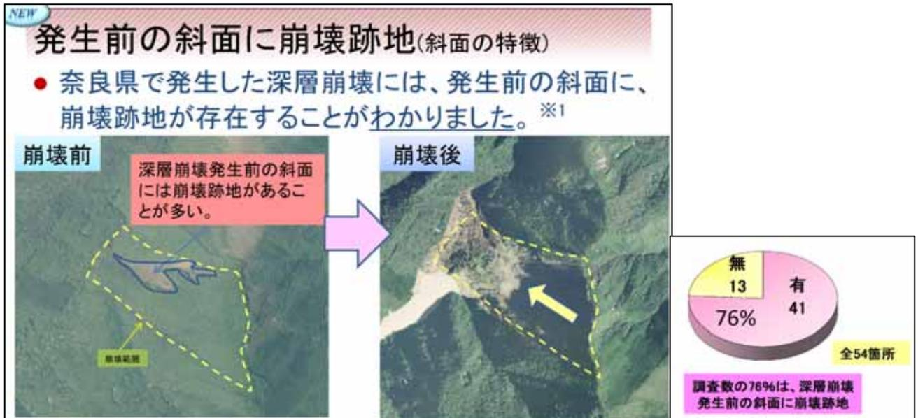
図 3.1.3 紀伊半島大水害において深層崩壊が発生した斜面の特徴
