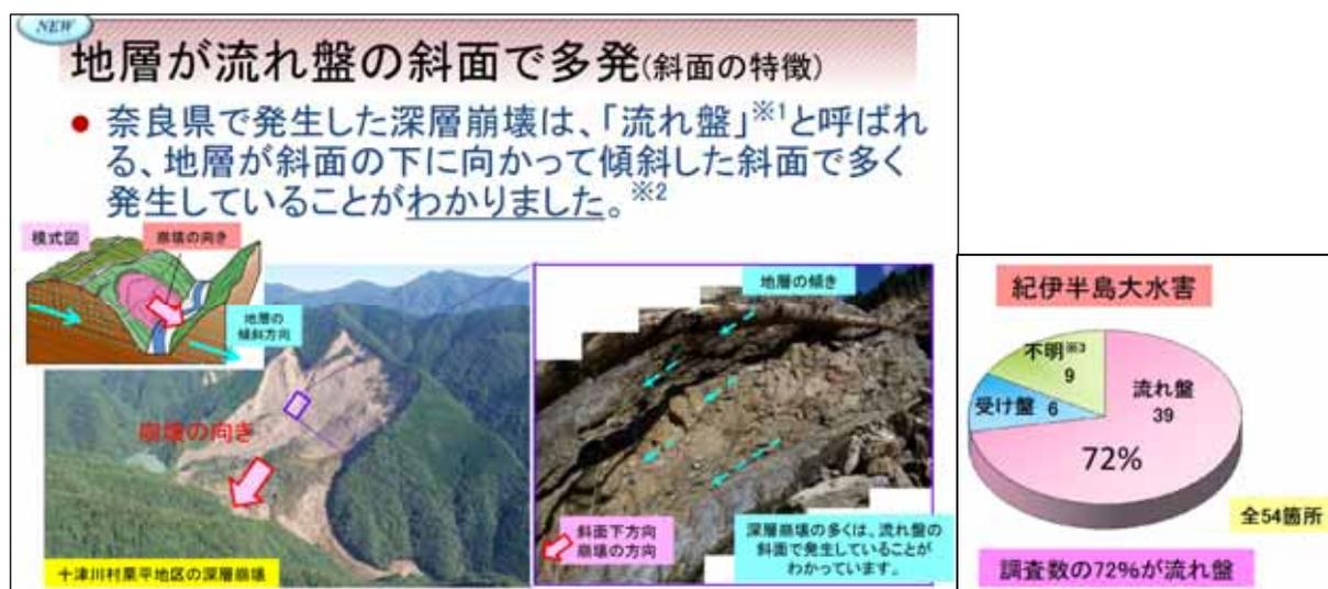
図3.1.4 紀伊半島大水害において深層崩壊が発生した斜面の特徴(流れ盤構造)
