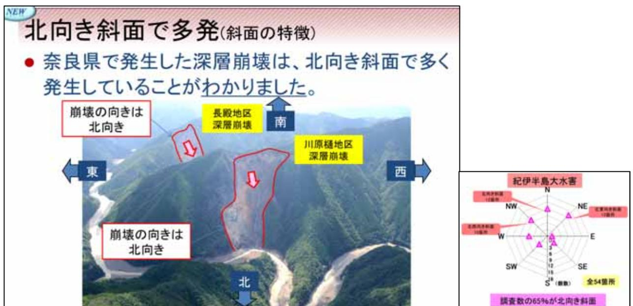
図 3.1.1 紀伊半島大水害において深層崩壊が発生した斜面の特徴（北向き斜面で多発）
